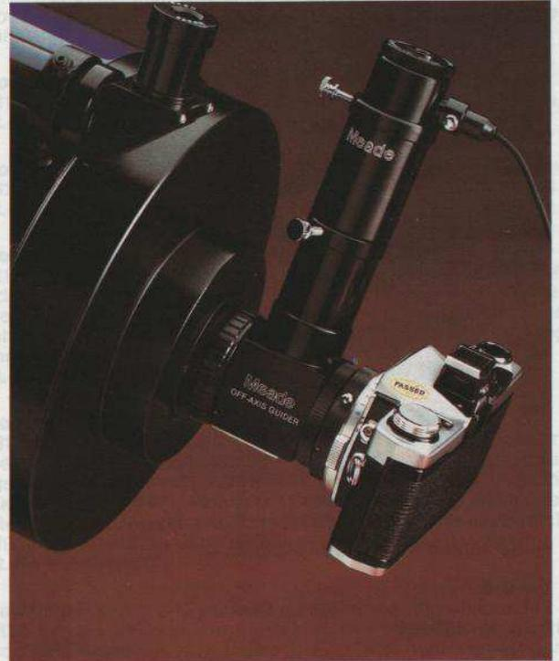
Die Abbildung zeigt das außeraxiale Nachführsystem, ausgebaut mit Shapley-Linse und Verlängerung für Fadenkreuzokular.
