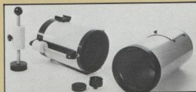
Flatfield-Schmidt 2, 2/400 SCL als High-speed Camera mit ebenem Bildfeld bis 60 mm Ø
