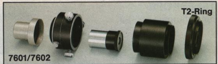
7601/7602 7601 Kamera Teleskop Adapter für Refraktoren 7602 Kamera Teleskop Adapter für Reflektoren (ohne Abbildung) Mit und ohne Okular benutzbar. Für Teleskope mit 24,5 mm Tubusdurchmesser. Für alle Systemkameras mit Wechselobjektiven. Gewinde für T2-Ringe. (T2-Ringe Sonderzubehör.) Bei Bestellung Kameramodell angeben.
